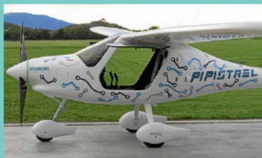
Den kann' ich doch: Die Zelle von WATTsUP basiert auf dem Alpha Trainer, der vom Rotax 912 angetrieben wird.
