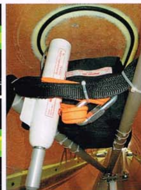
Das Junkers-Gesamtrettungssystem befindet sich im Rumpf der C42. Die Rakete wird im Notfall mitsamt Schirm mittig nach oben herausgeschossen.
