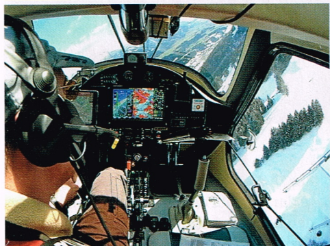
Avionikbauteile wie Geländedarstellung und Kollisionswarner schaffen zusätzliche Sicherheit. Landemöglichkeiten in den Bergen sind sehr eingeschränkt und erfordern oft Plan B oder Plan C.
