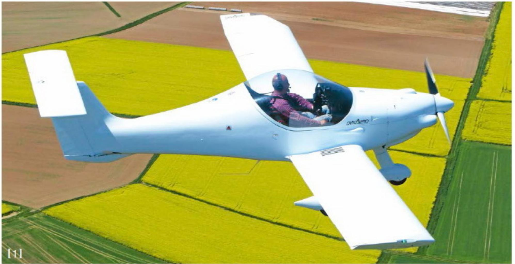
[1] Mit vergrößertem Flügel und getrennten Klappen und Querrudern erleichtert die ULC den fliegerischen Einstieg ins ultraleichte Hochleistungs-Segment. [2] DynAero geht mit der Zeit und setzt bei der Außenbeleuchtung auf LED-Technik. [3] Bei den aufwändigen Doppelspalt-Fowlerklappen kommt Technologie aus dem Airliner-Segment ins Spiel.
