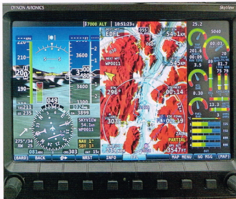
EFIS: Geländestrukturen und Flugparameter bis hin zum Angle-of-Attack-Indikator, der links im Bild neben der Geschwindigkeitsskala zu sehen ist.
