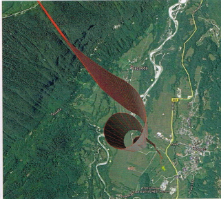
In IMC stieg der Virus bis auf 10 000 Fuß und wurde stetig langsamer. Es kam dann zu einem Strömungsabriss, dem ein Spiralsturz folgte.
