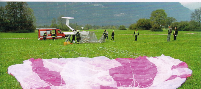
Die linke Tragfläche der Virus wurde im Sturzflug vollständig abgerissen, von der rechten blieb rund ein Drittel übrig. Der Schirm des Gesamtrettungssystems öffnete sich bei einer Geschwindigkeit von rund 500 km/h, obwohl er nur bis 310 km/h geprüft ist. Er rettete beiden Insassen das Leben.
