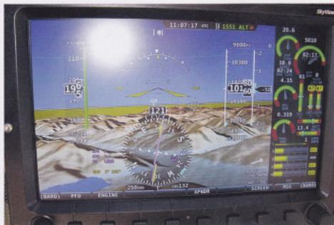
Das Dynon SkyView in Böhm's Cockpit zeigt 10 160 Fuß Druckhöhe und 11 009 Fuß Density Altitude (DA). Die Standardtemperatur in 10 000 Fuß beträgt  $-5^{\circ}\text{C}$ . Hier sind es  $+5^{\circ}\text{C}$ , laut Faustformel knapp 1200 Fuß mehr (120 Fuß pro  $1^{\circ}\text{C}$  ISA-Abweichung). Die IAS beträgt 196 km/h zur TAS von 231 km/h. Das sind 20 Prozent Differenz (2 Prozent pro 1000 Fuß).
