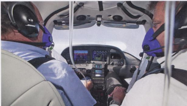
Ob klassische Sauerstoffmasken verwendet werden oder Nasenkanülen, liegt am persönlichen Wohlbefinden des Einzelnen. Der Vorteil bei Nasenkanülen ist die feine Dosierung, die auch längere Aufenthalte in großen Höhen für den Piloten oder die Besatzung bequem gestaltet.
