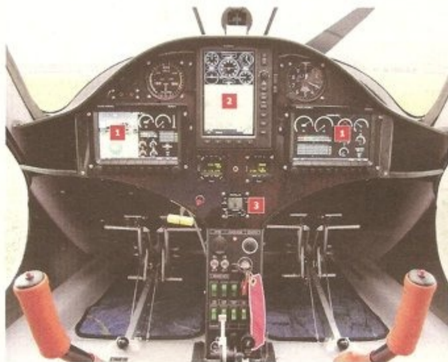
Virus SW mit Dynon Glascockpit (1), Garmin GPSMap 695 (2) und elektrischem Verstellpropeller (3)
