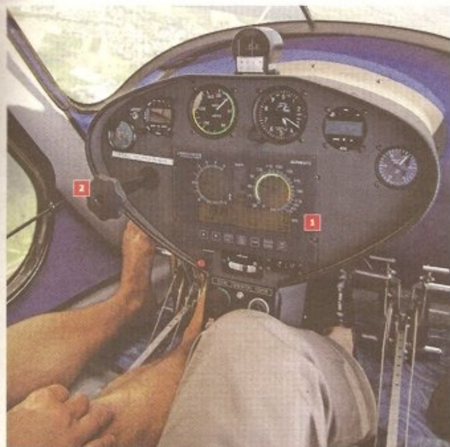
Sinus-Cockpit mit Brüniger AlphaMFD (1). Der Propeller ist hier im gefeathernten, widerstandsarmen Modus für den Segelflug (2).
